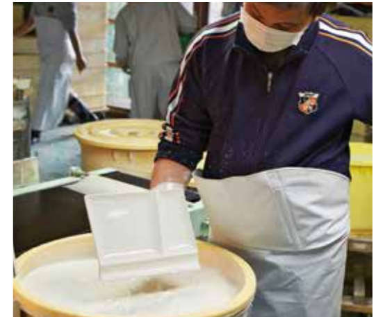
〈施釉:素焼きの器に液体状の釉薬を施します。〉
