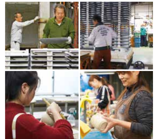
〈施釉:素焼きの器に液体状の釉薬を施します。〉
